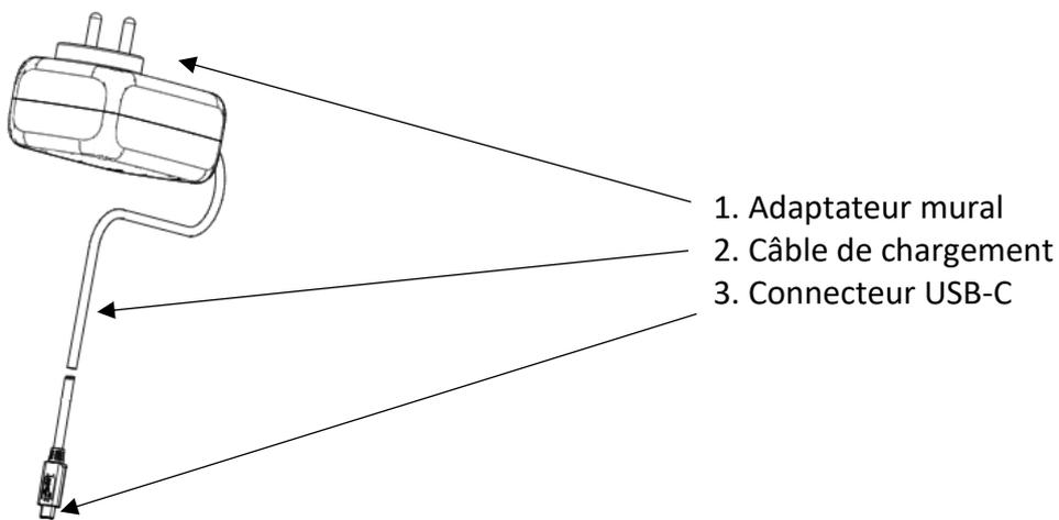
Figure 2 Chargeur de batterie de la sonde
