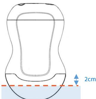
Figure 12 Limite d'immersion de la sonde echOpen O1
